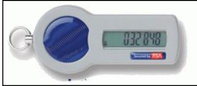
Un **TOKEN** si presenta spesso sotto forma di dispositivo elettronico portatile di piccole dimensioni, alimentato a batteria con autonomia nell'ordine di qualche anno, dotato di uno schermo e talvolta di una tastiera numerica.
