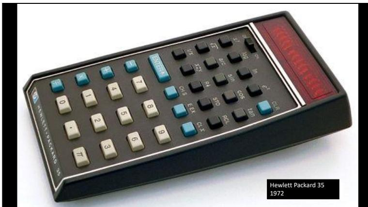
Ad appena un anno di distanza, nel 1972 Hewlett Packard lanciò la HP35. Era una calcolatrice "scientifica", ovvero non faceva solo le quattro operazioni base, ma si spingeva ben oltre disponendo di funzioni molto avanzate. Mandò in soffitta i regoli calcolatori. Una cosa geniale fu l'abolizione delle parentesi, sostituita da un sistema a memorie mobili, che caratterizzò la produzione Hewlett Packard di tutte le macchine simili prodotte successivamente
