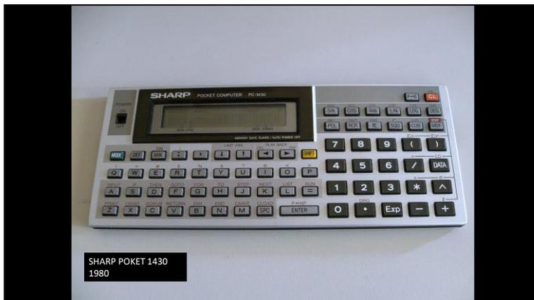
Le macchine Texas Instruments e Hewlett Packard fin qui presentate erano delle calcolatrice, evolute e potenti, ma pur sempre basate sui calcoli di cui erano capaci. I computer invece disponevano di linguaggi di programmazione (ad esempio il Basic). I tempi erano maturi per miniaturizzare il tutto. La foto mostra un minicomputer Sharp POKET 1420, è del 1980. Usava un linguaggio Basic ed era collegabile con l'esterno
