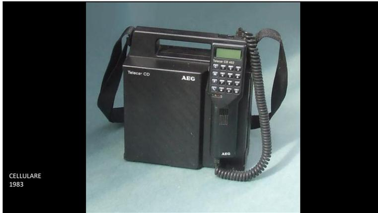
Il progresso non si arresta, ed invade il campo delle telecomunicazioni. Siamo nel 1983 e compaiono i primi telefoni portati (detti “cellulari” perché funzionano su celle coperte da un ripetitore). Naturalmente i primi erano ingombranti (anche perché le celle erano grandi e bisognava disporre di adeguata potenza di trasmissione)
